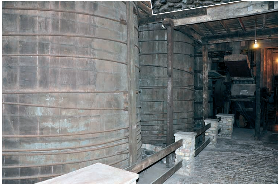
Die riesigen hölzernen Gärbottische wurden 1892 eingebaut. Sie stammen aus Paisley in Glasgow.
