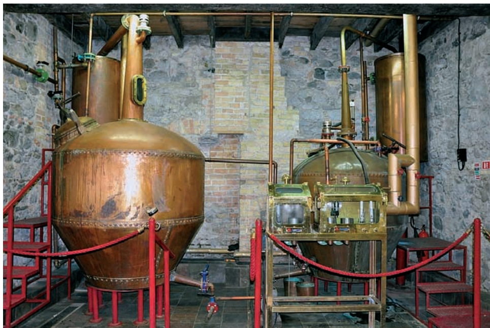
Die Destillationsanlage mit der neuen Wash Still aus Schottland (2007) und der historischen Spirit Still (wohl 1830) aus der Tullamore Distillery erlaubt die zweifache und mehrfache Destillation. Sie dient Cooley Distillery Plc ebenfalls als Testanlage.
