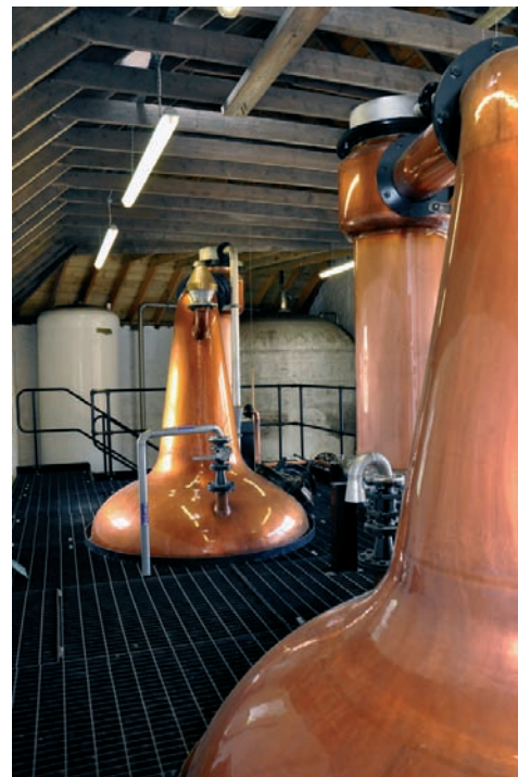
▲ Das Still House mit den kupfernen zwiebel-förmigen Brennblasen
